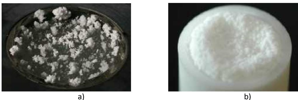
**Figure IV.1-** Exemples d'efflorescences (a) Efflorescence chou-fleur (b) efflorescence croûte
