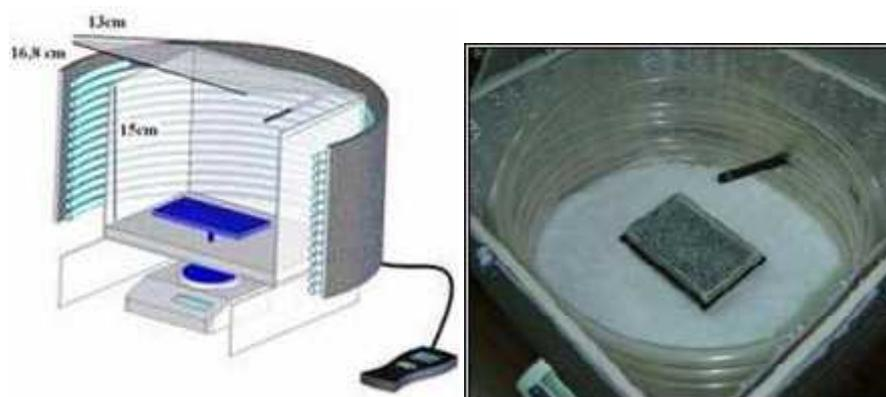
**Figure II.4-** Schéma de l'enceinte a) Dimensions b) Schéma du micromodèle installé dans l'enceinte avec le système de pesée et le serpentin permettant de contrôler la température et la couche de LiCl permettant de contrôler l'humidité relative dans l'enceinte.
