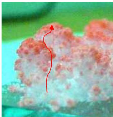
**Figure IV.10-** L'efflorescence chou-fleur est poreuse. Une solution aqueuse colorée mise en contact avec de l'efflorescence sèche est aussitôt pompée par capillarité jusqu'au sommet de l'efflorescence où les flux d'évaporation plus élevés induisent un dépôt préférentiel du colorant.
