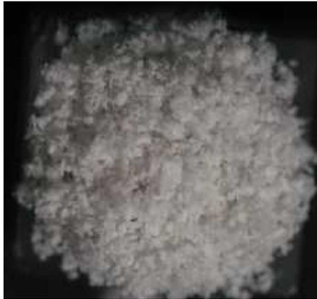
**Figure IV.28-** Fin de séchage pour la valeur 71% d'humidité et 35°C de température pour un empilement de bille de taille 5-50 $\mu\text{m}$
